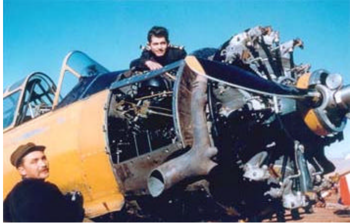
Mécaniciens de l'escadrille 6/72 lors de la révision périodique d'un T-6 . Cet appareil n'était pas un modèle d'aérodynamisme et restait peu rapide malgré un excellent moteur Wasp de 600 ch (environ 200 km/h en croisière). Sur les lieux d'opérations, il fallait solliciter anormalement le moteur à 2000 tours/minute et 30 pouces de pression d'admission, alors que la norme se situait à 1850 tours et 26 pouces. Collection Pierre Denis
