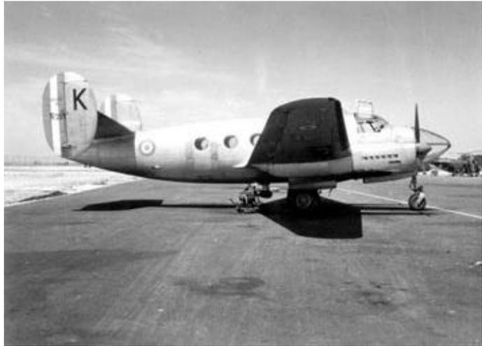
MD-311 au nez vitré. Cette version du Flamant pouvait être armée de six missiles filoguidés AS 11, que le radio-navigateur tireur d'engin pouvait guider depuis le nez vitré à l'aide d'un petit manche de télécommande. Ce type de projectile était essentiellement utilisé pour déloger les rebelles des grottes. Le MD-311 était également utilisé pour des missions photos. D.R.
