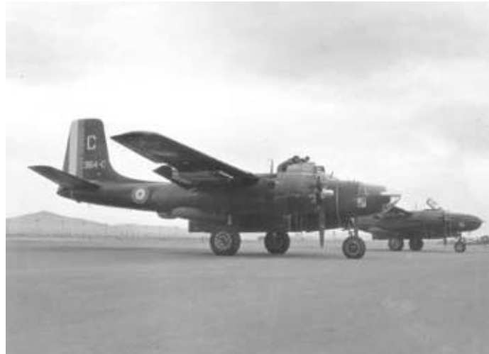
Au premier plan, avec le nez vitré, un B-26 leader du GB 1/91 Gascogne sur la base aérienne de Bône-les-Salines. Sous son plan droit, l'on remarque quatre roquettes. En second plan, un B-26 straffer.
