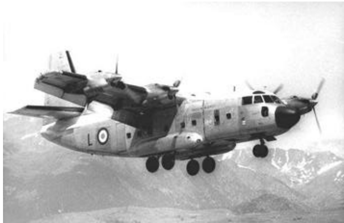
Le 941S militaire en 1967. Sa technologie des ailes soufflées lui permettait d'opérer sur des terrains très courts et inaccessibles à des appareils plus classiques.
