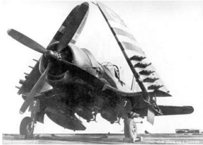
Configuration d'armement standard pendant la campagne de Suez. Cet appareil de la 15F transporte deux bombes de 1000 livres et un réservoir largable.
