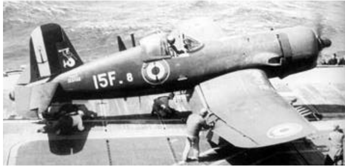
Préparatifs et accrochage sur la catapulte pour le 15F-8, un F4U-7.
