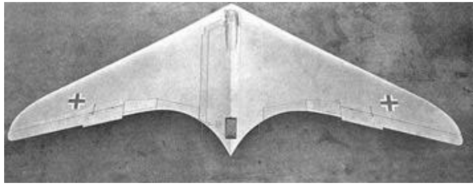
Un Ho IX V1, prototype des Go 229. Il correspond tout à fait à l'esprit des Horten: il s'agit d'un planeur, aile volante très pure, qui sera motorisé ultérieurement. Coll. Reimar Horten
