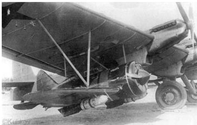
Arrimage de l'un des deux Polikarpov I-16 SPB (bombardement en piqué) type 5 sous un TB3 4M-34RN lors des essais officiels lors de l'été 1938. Collection V. Kulikov
