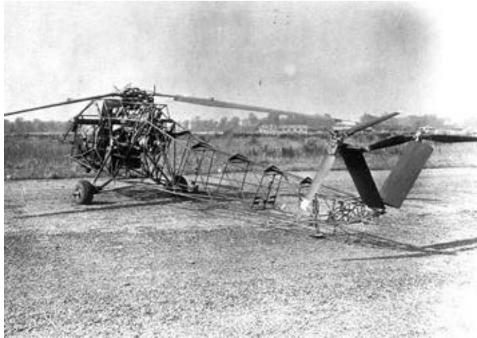
Sur ce cliché du SE 3101-01 sur le terrain de Villacoublay, on distingue bien l'empennage papillon à 45° et ses deux rotors anti-couple bipales. CEV, Collection Ph. Ricco
