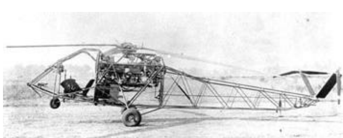
Vue latérale du SE 3101-01 montrant bien l'architecture sommaire de cet appareil, de ce fait allégé au maximum. Le faible moteur en ligne Mathis occupait tout de même une place importante sous le rotor.
