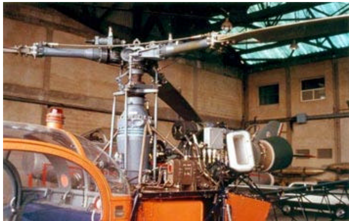
Détail du rotor et de la turbine "Artouste" de la SE 3130 n°1864 F-GDHP, dans un hangar de Marignane. Photo D. Liron
