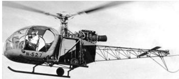
SE 3130 n° 1129 (N 527) avec moteur turbine "Lark" (Aviation Magazine)
