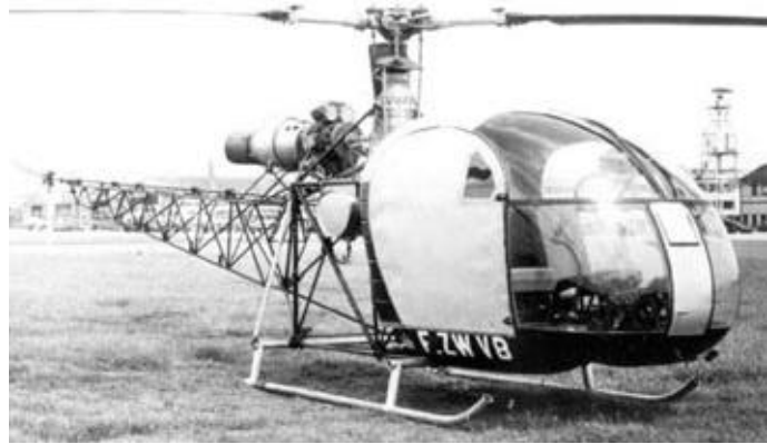
SE 3150-001 F-ZWVB en configuration "record d'altitude" équipé d'un mini-réservoir et du panneau de porte en plexiglas. Gain de poids oblige !
