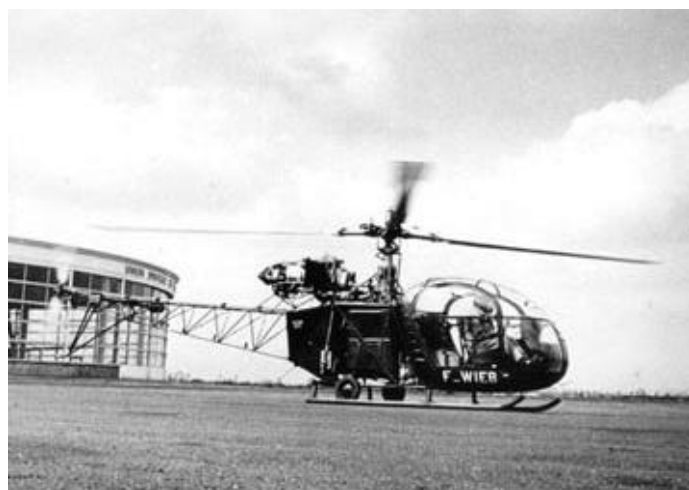
SE 3140-01 F-WIEB, le banc d'essais volant doté du turbomoteur TURMO II sur le terrain du Bourget (rotor principal normal de 10,20 m) Sud-Aviation. Collection de l'auteur.
