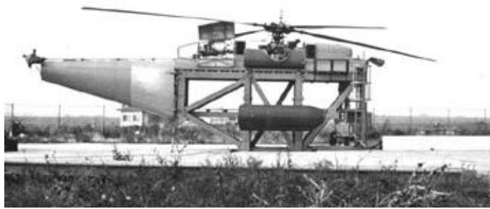
Chaîne dynamique du Frelon au banc d'essais du Bourget. Photo X Collection Liron
