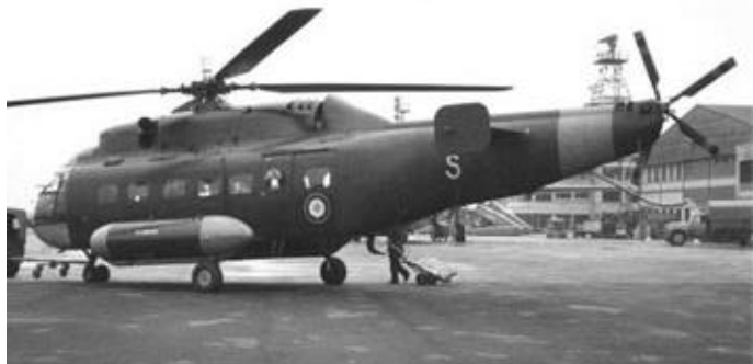
SE 3200-001 Frelon 2 ème version avec rotor anti-couple à 5 pales. Photo Pierre Gaillard
