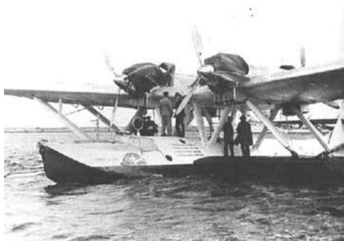
Le Laté 300 "Croix du Sud" était un hydravion à coque dont les moteurs étaient installés en tandem. D.R.
