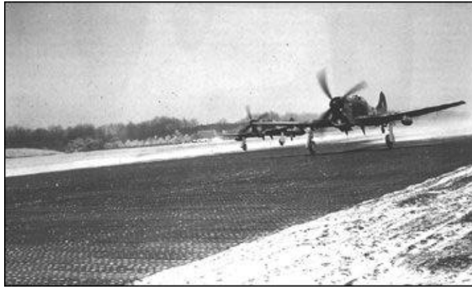
Avril 1945 : deux Tempest V du 274 Squadron décollent depuis la piste en plaques Marston (PSP) de Kluis. RAF Museum
