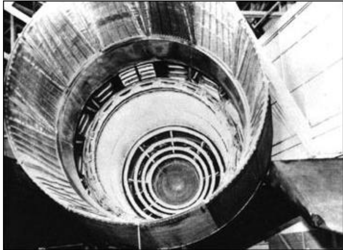
Sur ces deux vues arrière, on peut voir les rampes de post-combustion du J58. On constate une légère différence dans la forme des cornières entre le YF-12, photographié en 1964 (ci-dessus), et le SR-71 (ci-dessous), photographié une dizaine d'années plus tard.
