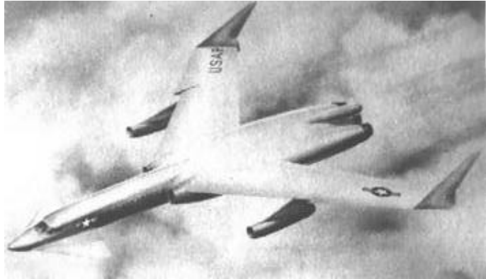
Cet étrange appareil expérimental, le Convair NX-2, devait être construit en deux exemplaires pour tester les réacteurs nucléaires de General Electric et de Pratt & Whitney. En effet, une variante atomique du J-58 fut sérieusement envisagée. © Convair
